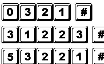
Activation de la sortie forcée (sortie commute vers la masse) et sortie 1 est activée pendant 1 seconde
