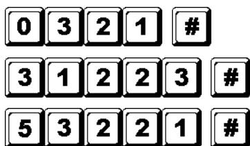
De duress-uitgang wordt geactiveerd (uitgang schakelt naar aarding) en uitgang 1 wordt geactiveerd voor 1 seconde
